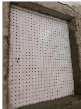
图5 通风隔声板的本体隔声量测试
